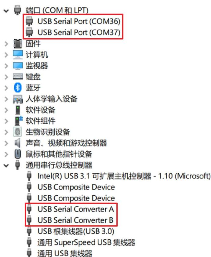
图 9-7 设备管理器中显示两个串口
